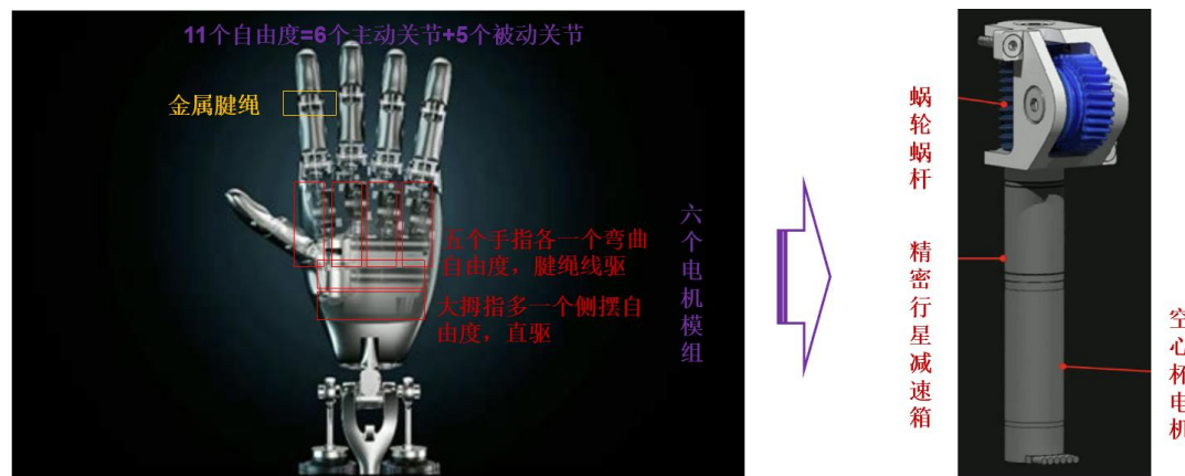
图表17：特斯拉灵巧手结构拆分
