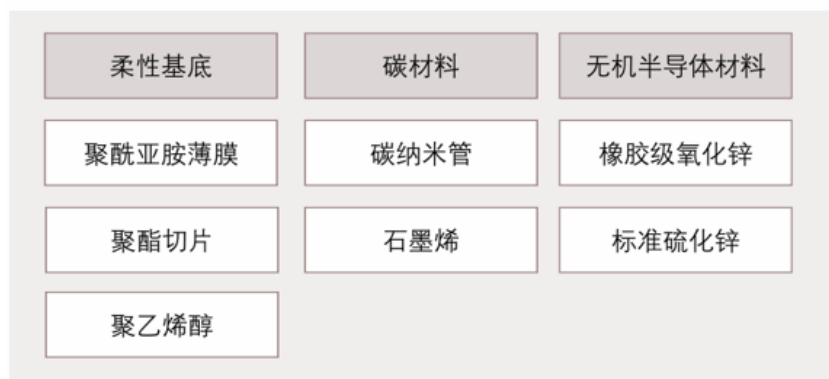
图表20：机器人触觉皮肤仿生材料
