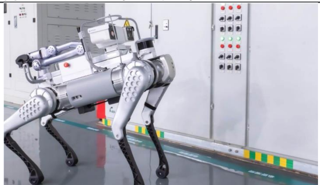
图22: Unitree B2 参与电力巡检
