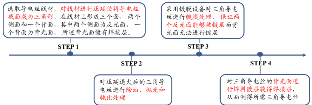
图49：三角导电丝的制备流程
