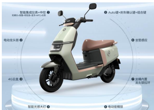
图23: 爱玛电动两轮车实现的简单及高级智能功能
