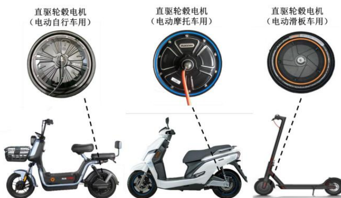
图31：直驱轮毂电机应用于电动两轮车产品
