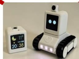
机器人两侧和顶部可使用ESP32-S3自带的触摸交互
