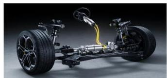
**主动调节**：可结合 AD 感知系统，对道路状态预瞄，调整悬架高度和阻尼，可实现对车的纵横垂三向六自由度精准调控；
