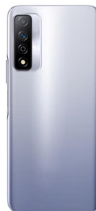
图35: 仿阳极氧化涂料应用实例
