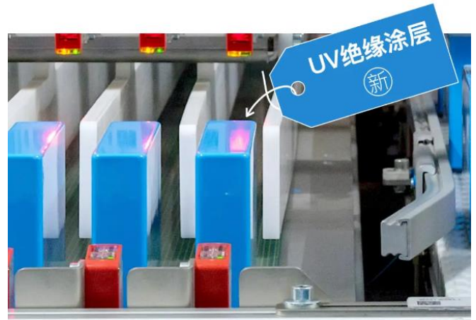
图50: UV 涂覆绝缘层
