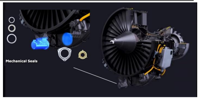
图 25： 航空发动机中的机械密封件
