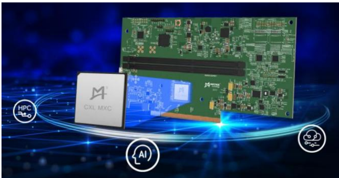
图 15: MXC 芯片目前主要的两种产品应用形态之一: AIC (Add In Card) 连接标准 DDR5/4 内存模组
