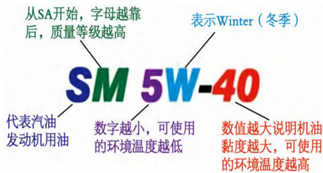
图 23：API 汽油发动机机油标号的含义
