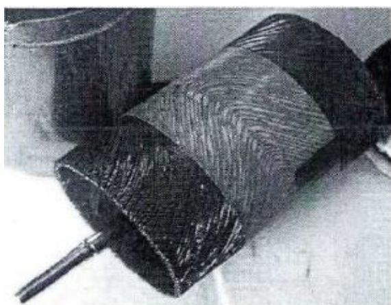
图 36: 一次性绕制成型空心杯电机线圈
