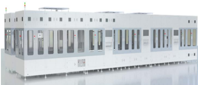
◆ 图：利元亨高速切叠一体机叠片速度达0.15s/pcs（三工位）
