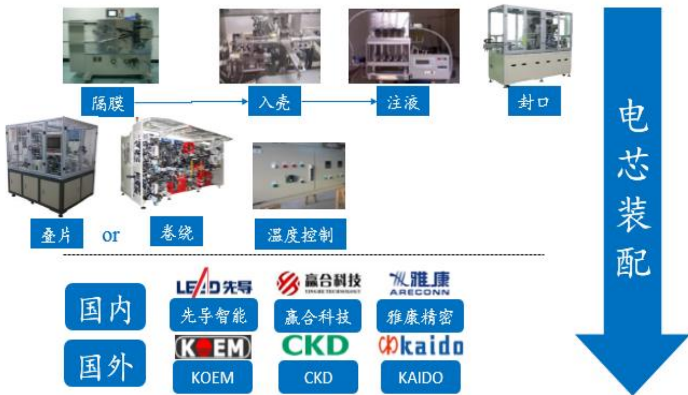
◆图：电芯装配流程及主要设备供应商
