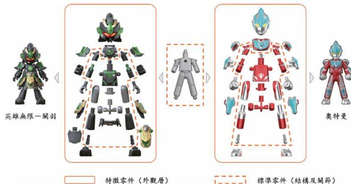
图：布鲁可拼搭角色类玩具架构
