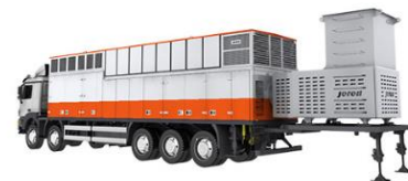
6MW级移动式燃气轮机发电机组
