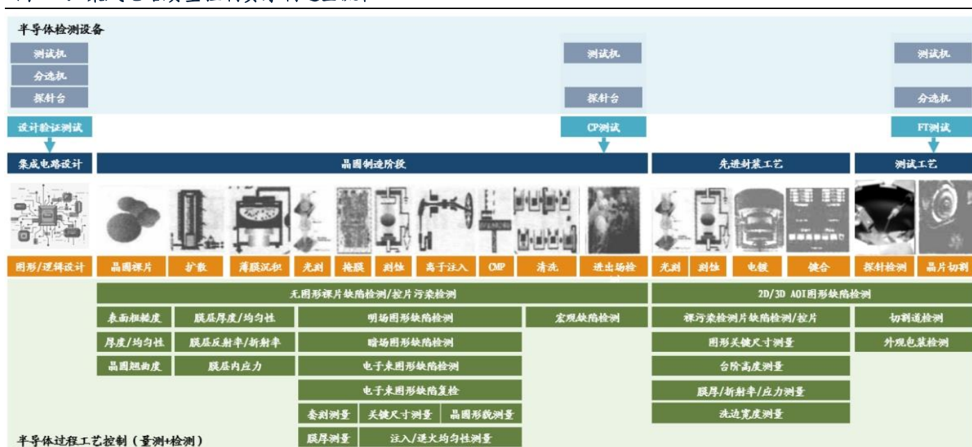
图 12：集成电路质量控制贯穿制造全流程
