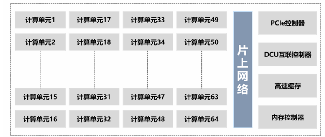
图 21：海光 DCU 基本组织架构示意图
