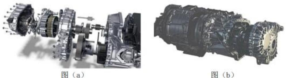
资料来源：公司招股说明书（注：图（a）为保时捷首款纯电动跑车 Taycan4S 配备的两挡变速器；图（b）为吉利超级跑车路特斯 ELETRE 搭载的两挡变速器）
