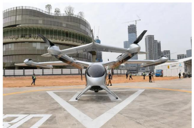
图表 52: 5 座 eVTOL（电动垂直起降）航空器
