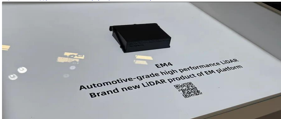
图16：速腾聚创 EM4 拥有最高 1080 线、最远 600 米测距
