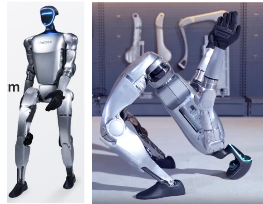
图58：G1量产版最高43个自由度，超大关节运动空间角度
