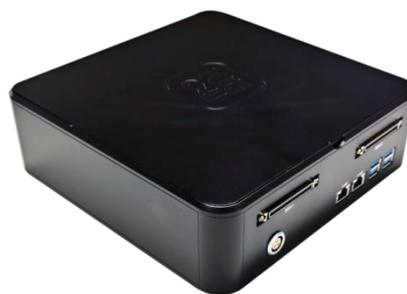
“CortexR5+Cortex-A53”异构多核架构，实现 MATLAB/Simulink、C/C++、FORTRAN、Dymola、MWORKS 等建模软件生成的数学模型在仿真仪的快速部署，开展 $\mu\text{s}$ 级步长仿真，并提供 AD、DA、DIO、PWM、RS232/422/485、CAN、1553B、无源开关量等信号接口，实现了从底层软件基础开发环境到应用层的全面国产化，用于单机设备测试、快速原型验证、硬件在环测试、系统集成验证等多种应用场景。
