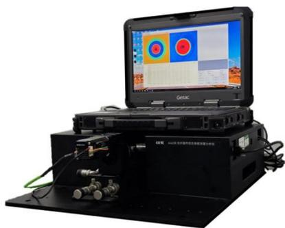
十一研究所通过突破宽光谱可调滤波光信号产生、基于 LED 斜向照明的光纤端面成像等关键技术，研制了综合性能国际先进的光纤参数综合测量仪，包层直径测量范围  $80\mu\text{m} \sim 500\mu\text{m}$ 、测量精度  $\leq 0.5\mu\text{m}$ ，模场直径测量范围  $4\mu\text{m} \sim 15\mu\text{m}$ 、测量精度  $\leq 1\%$ ，为百余家光通信用户单位提供了测试计量保障。
