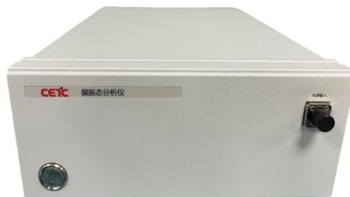
为 1MHz，偏振方位角和椭圆度测量最大允许误差为 $\pm 0.25^\circ$ ，技术指标与国外最先进产品相当。通过 6213A 偏振态分析仪，能够为偏振控制技术提供全面的量化指导，从而更高效的解决环境噪声导致的偏振误差问题。
