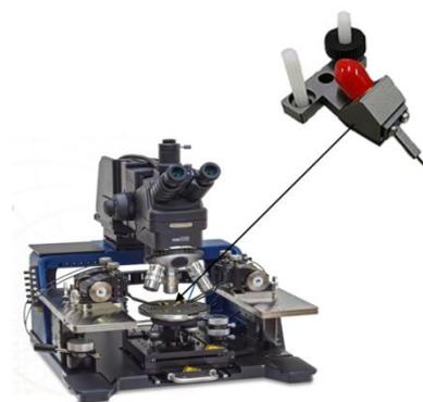
DC~110GHz，其中 DC~110GHz 探针回波损耗 $\leq -15\text{dB}$ ，插入损耗 $\leq 1.2\text{dB}$ ，可靠性测试寿命高于 75 万次，针尖宽度最低至  $20\mu\text{m}$ ，处于国内领先水平，主要应用于高频芯片半导体工艺
