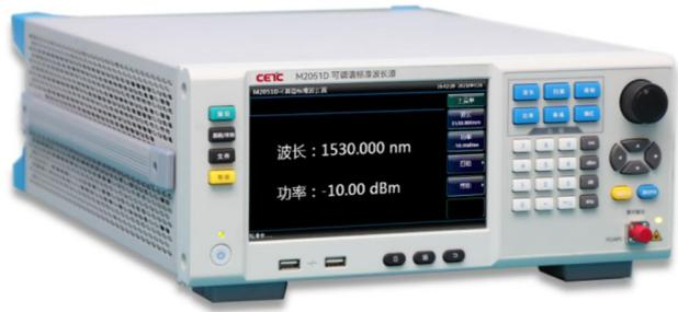
第四十一研究所推出的 M2051D 可调谐标准波长源，采用先进的光学、结构设计，实现稳定可靠、精确高效的连续可调激光输出，是一款集合宽调谐范围、高波长稳定性的高性能可调谐激光光源。M2051D 可调谐标准波长源具有波长分辨率高、线宽窄、调谐范围宽等特点，波长范围 1500nm 至 1640nm，波长精度 $\pm 3\text{pm}$ ，线宽小于 100kHz，技术指标和国外先进产品相当，能够满足光电计量、光谱分析等领域的测试需求。
