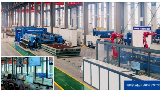
图表65: 公司所产的高铁轨道板自动化生产线
