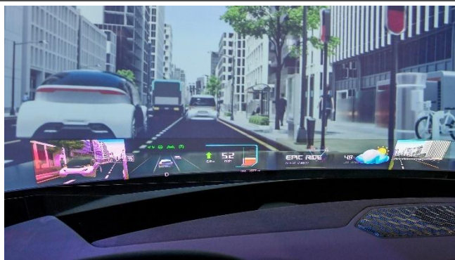
图53：现代摩比斯全息宽幅挡风玻璃显示屏
