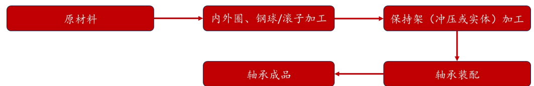
图表 11：轴承制造主要工艺流程
