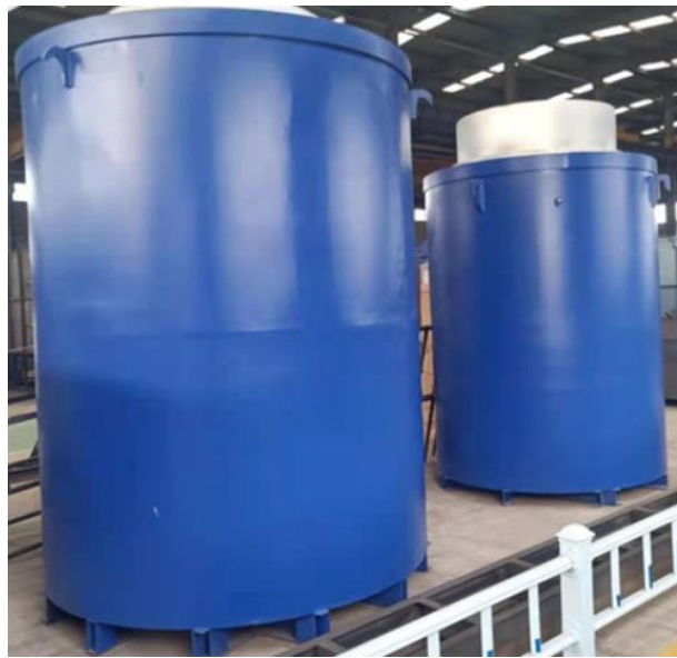
图表84: 井式热处理炉适合于长轴类零件热处理
