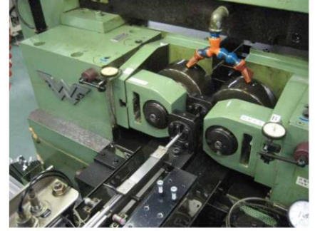
通过滚丝模进行的冷轧加工
