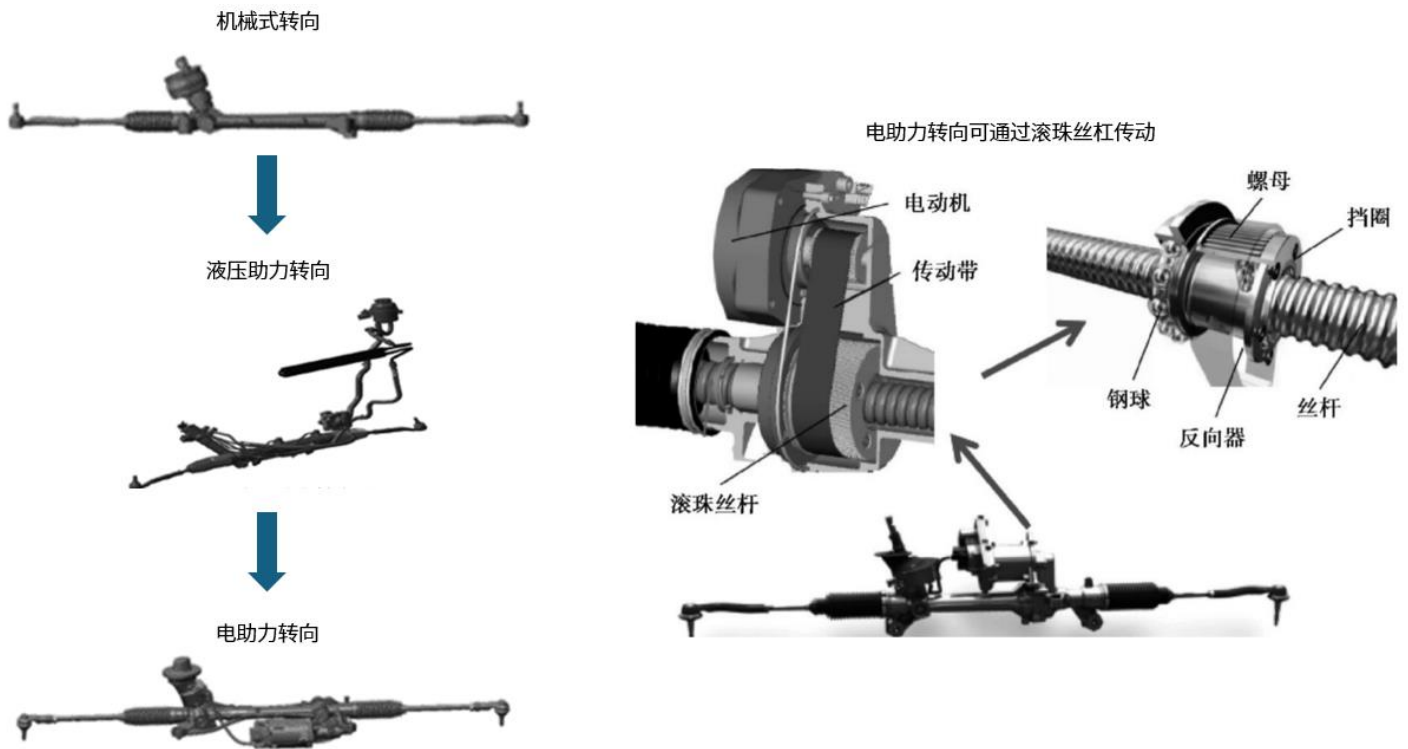
图表71：电动助力转向系统可采用滚珠丝杠作为传动机构
