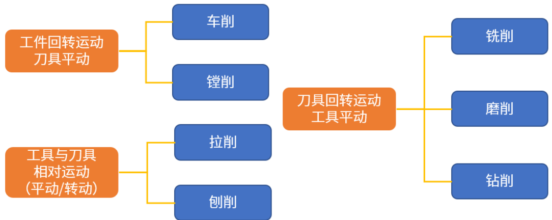
图91：金属切削加工根据工件/刀具相对运动关系的分类
