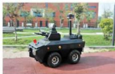
安防巡检机器人
