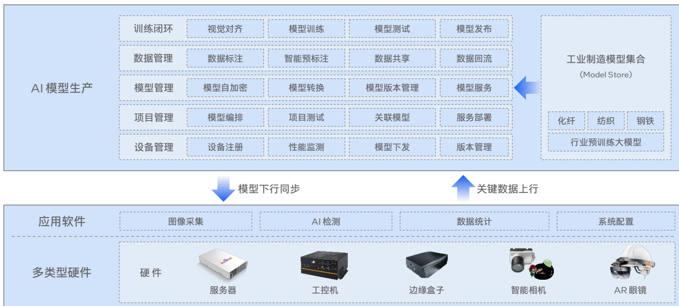
图1. 百度智能云工业智能质检方案架构
