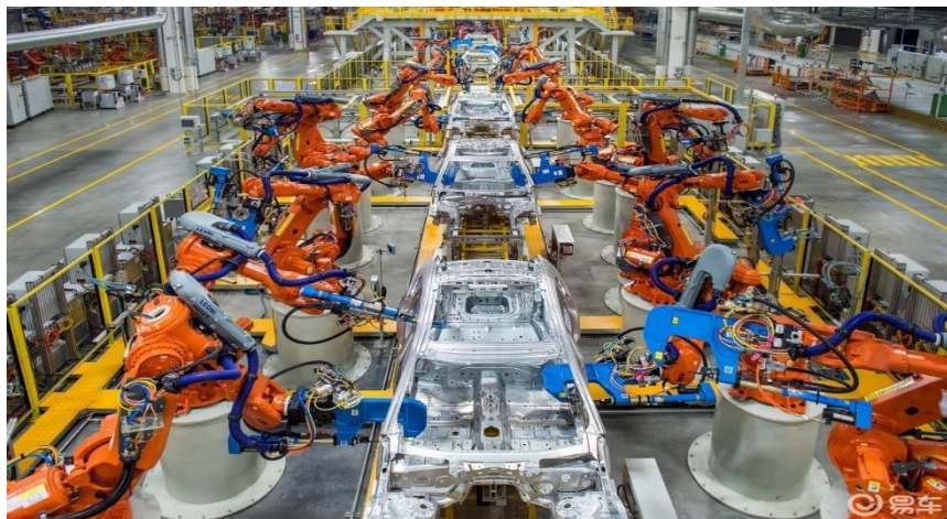
图：固定工位的汽车焊接机器人
