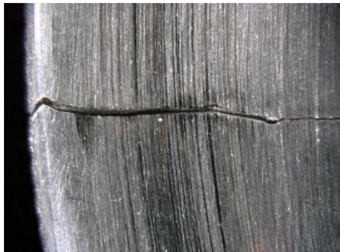
长时间运行后柔轮的裂痕
