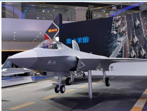
图表14：歼-35 模型前起落架有明显的弹射牵引杆
