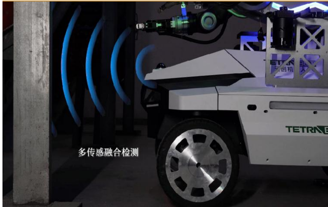
图 10: 天魁1号绝对运动精度能达到±0.1 毫米
