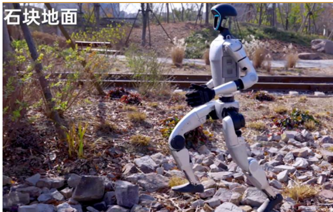
图 2: G1 在碎石路面稳定运行
