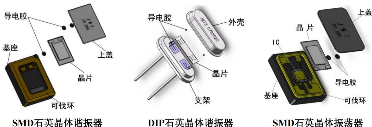
图1：公司石英晶振产品结构示意图
