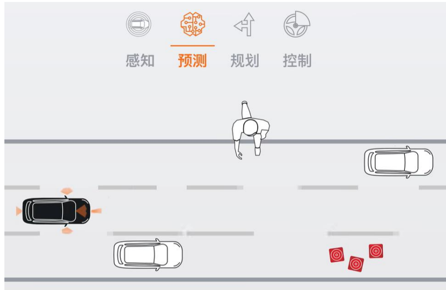
图表 12. 传统辅助驾驶的模块化架构
