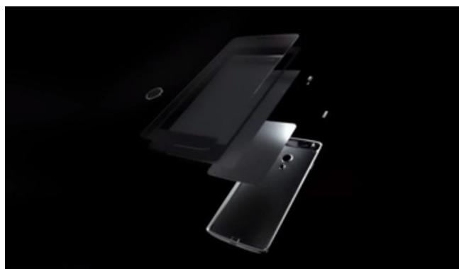
图表 55：压触执行器可用于手机屏下触控模组
