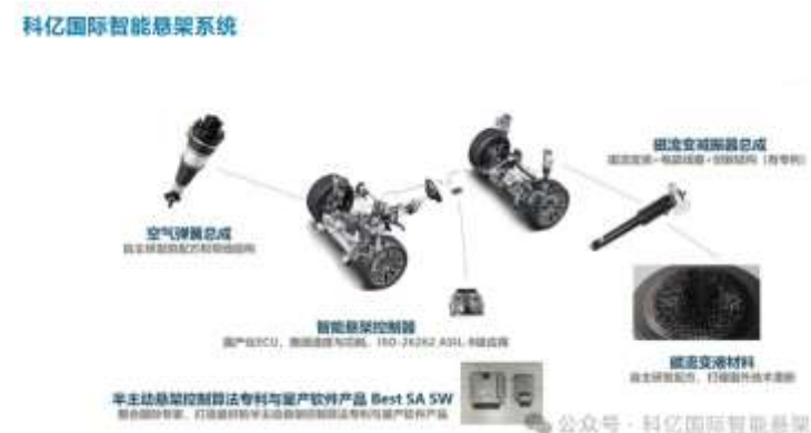
图表61：磁流变智能悬架系统
