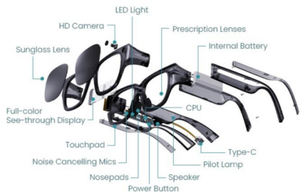
图18: AR 眼镜结构拆分 (INMO air 2)
