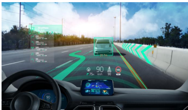
图14: 抬头显示器（AR-HUD）示意图
