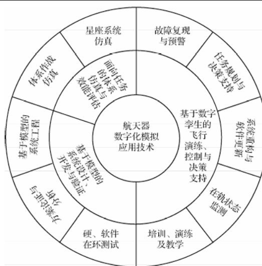
图5：航天数字仿真可应用于航天器系统工程中的设计、测试以及运维等环节
