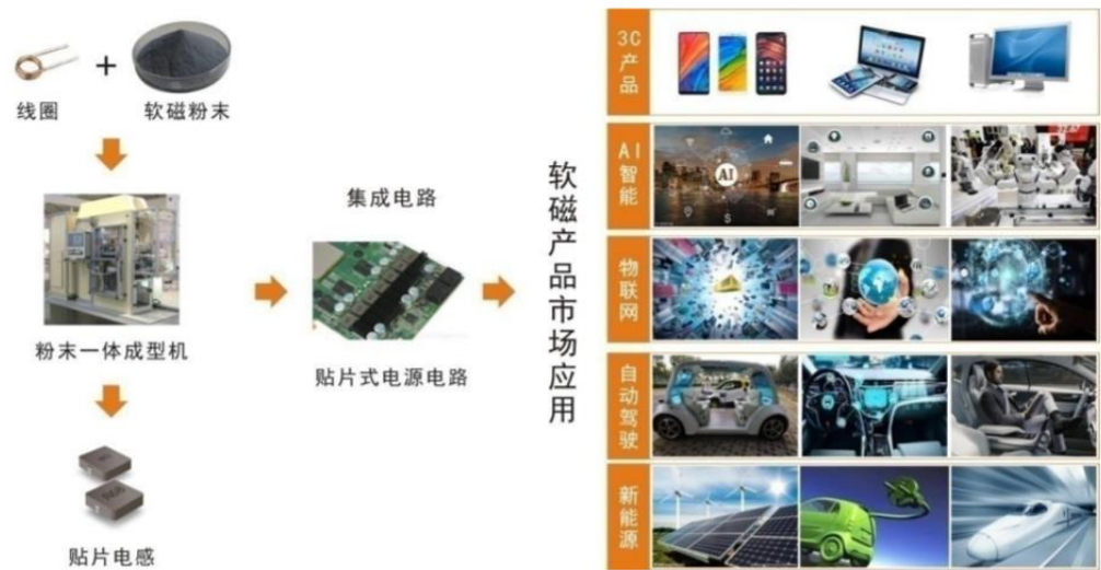
图108 软磁粉主要用于制造磁芯及电感元器件
