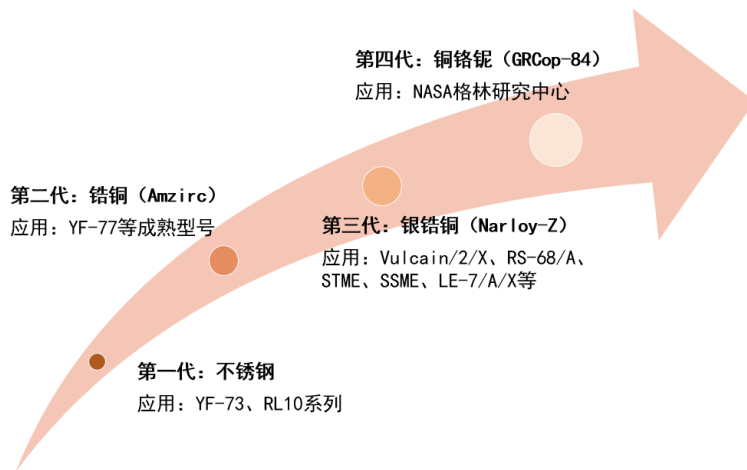
图94 推力室内壁材料的迭代进程
