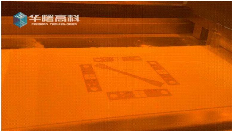
图116 华曙高科 UT252P 设备打印 PEEK 材料
