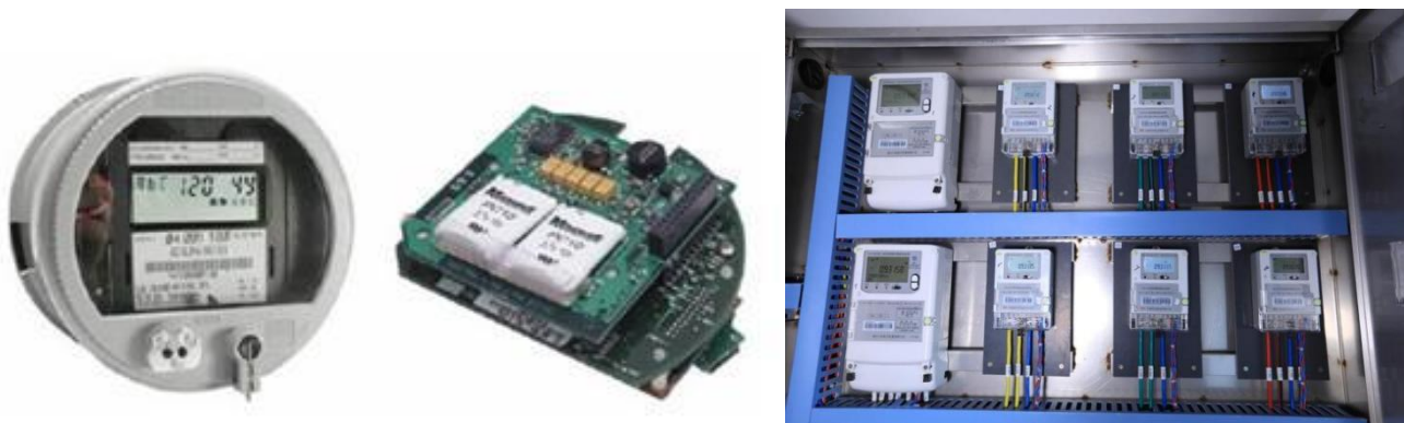
图24：超级电容在智能电表的应用及“LastGasp”新型智能电表采集系统
