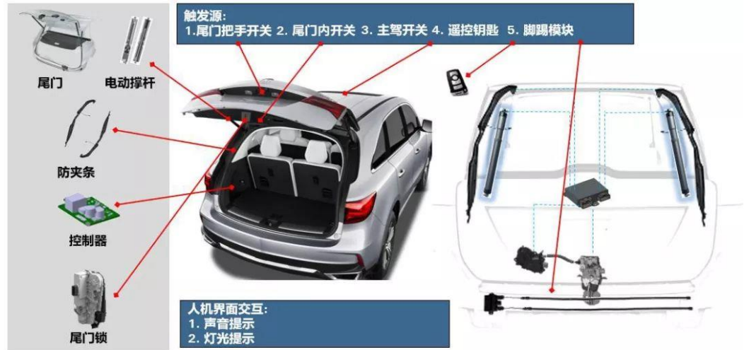
图17 电动尾门结构示意图
