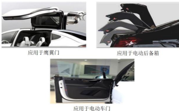
图15 后备箱及侧门电机的应用情形
