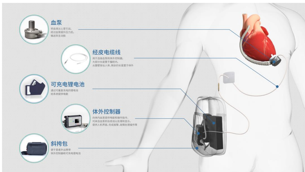
图表50：同心医疗“慈孚”植入式左心室辅助系统示意图
