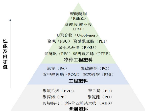
图表94: PEEK 综合性能处于塑料金字塔顶端
