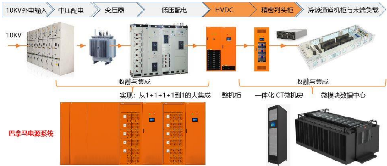
图表46：中恒电气 HVDC-巴拿马电源系统通过模块化、集成化设计可节省占地面积 50%
