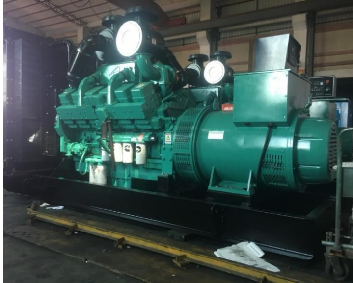
图表69: 康明斯 qsk60 系列数据中心用 2000kWh 柴油发电机组
