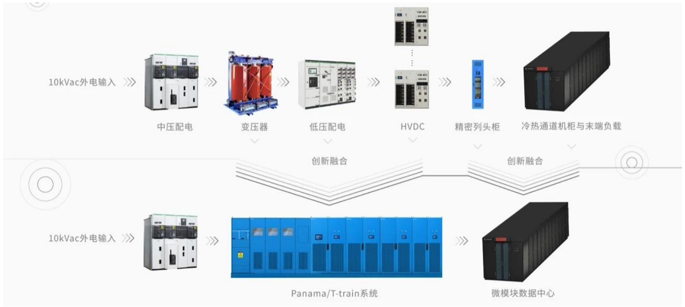
图表19: 中恒电气为腾讯供货的 T-Train 火车头系统整体架构与巴拿马电源类似
