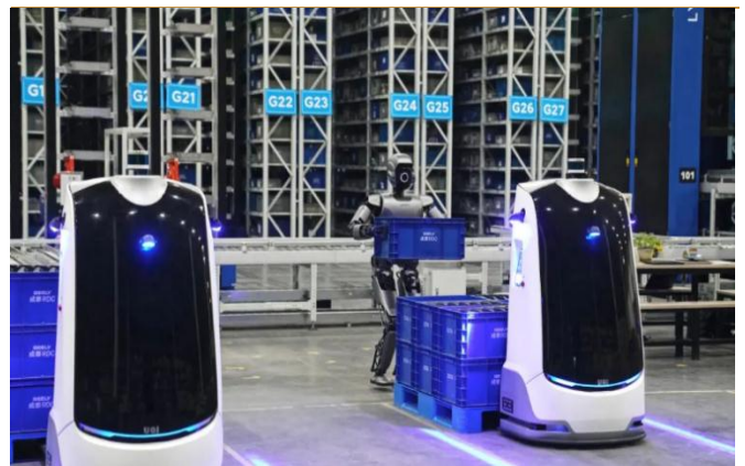
图 10：Walker S1 与 Wali 瓦力无人叉车 F1200S 协作完成汽车零件入库
