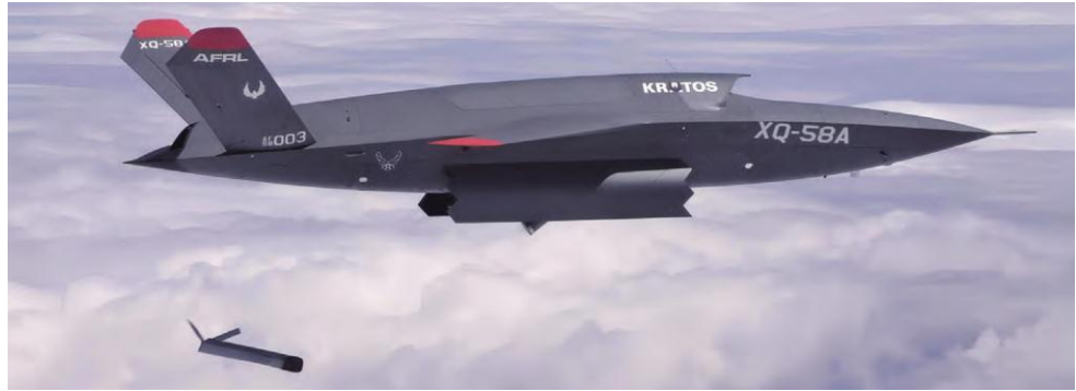
图 26: X-58A 无人机投放 Altius-600 巡航导弹
