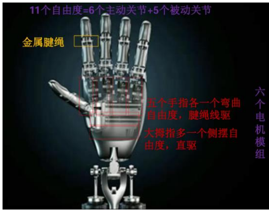
图9：第一代“空心杯电机”灵巧手方案
