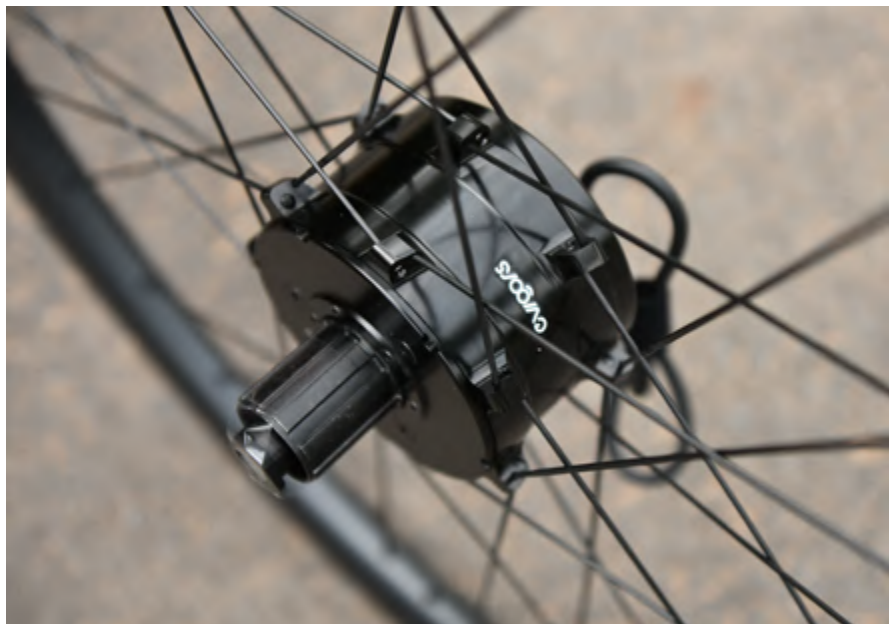
EVIGORS E7 适配市面上大部分自行车的变速系统，电机主体仅重 2100 克。
