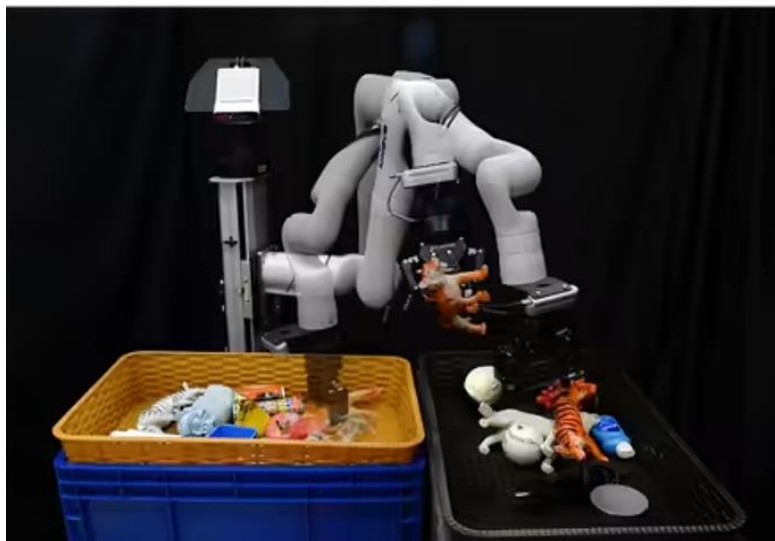
图：GR-2对超过100个物体进行端到端的集装箱拾取
