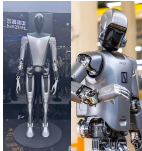
图：视觉方案差异化：纯视觉（左）、多传感器（右）
