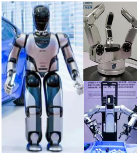
图：手部方案差异化：五指（左）、三指&夹爪（右）
