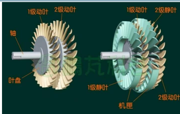
图表90: 燃气轮机涡轮动叶与静叶结构图
