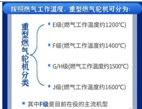
图表22: 按照燃气温度, 重型燃气轮机可分为 E、F、G、H、J 级
