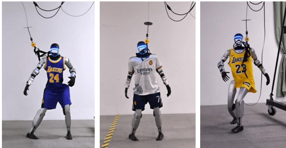
图表：应用ASAP的宇树机器人能复刻科比等球星招牌动作
