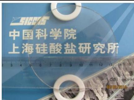
AION 透明陶瓷 (直径100mm×5mm)
